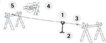
1. Laufkatze aus Edelstahl, Trageseil verzinkt,  $\varnothing$  10 mm, Länge: 25 m
